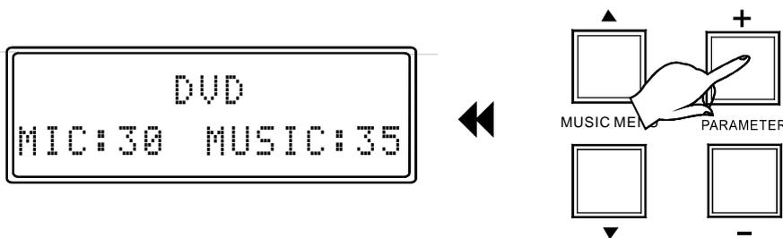
當顯示屏顯示左邊菜單時, 按住 "+" 按鍵 3秒鐘, 屏幕出現 "Function lock enable" 時表示加鎖成功。加鎖后音樂只有音量, 運行模式, 變調, 消聲, 信號選擇可以調。話筒只有音量和效果電平可以調。
